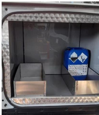
4. Copertura delle parti posteriori del rivestimento interno del vano di carico in prossimità del portello posteriore, tramite pannelli sagomati in acciaio fioretato AISI 304 con sigillatura per copertura delle parti esposte al taglio e resa ermetica dell'accoppiamento dei pannelli.
